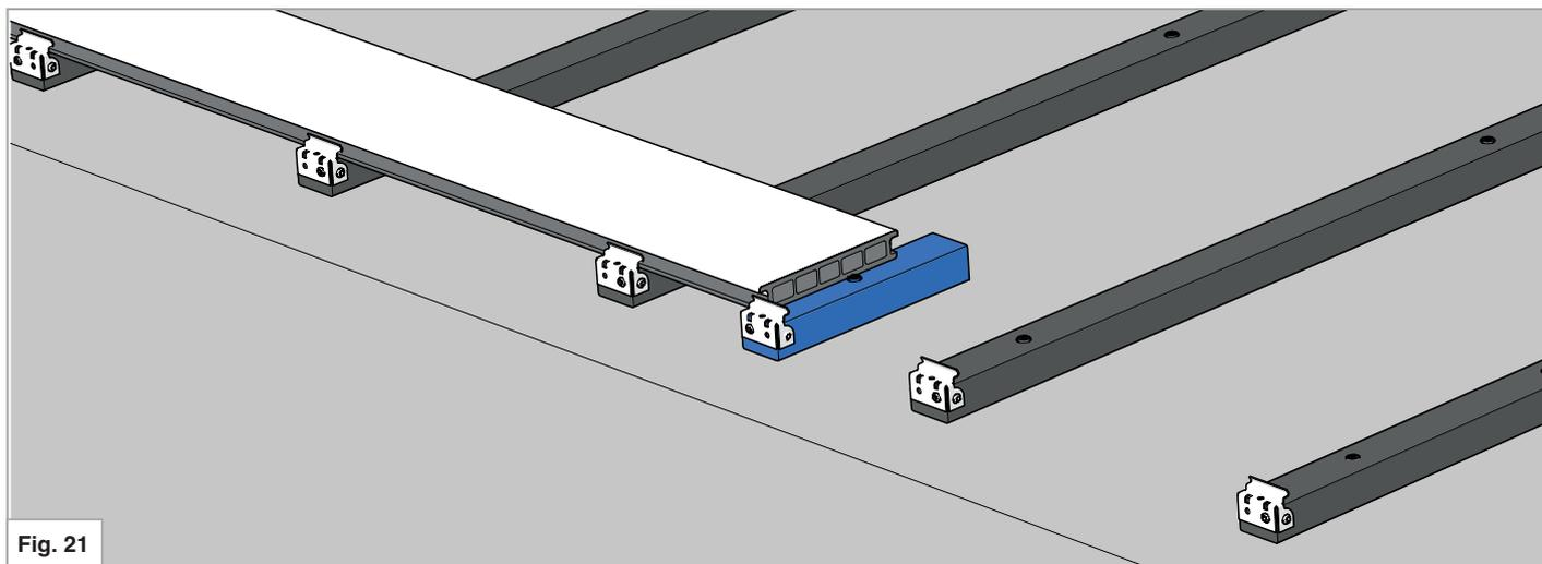
Pour faciliter la pose des lames à l'aboutage, découpez un bout de lambourde d'une longueur d'au moins 200 mm et fixez la au niveau de l'aboutage.
