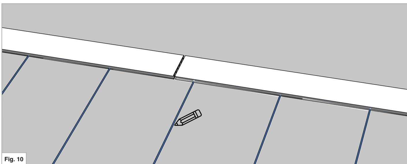
Disposez la première lame de terrasse sur le sol et tracez au préalable l'emplacement des lambourdes en respectant l'espacement déterminé par l'orientation choisie pour les lames (Cf. Fig 1,2 et 3).
